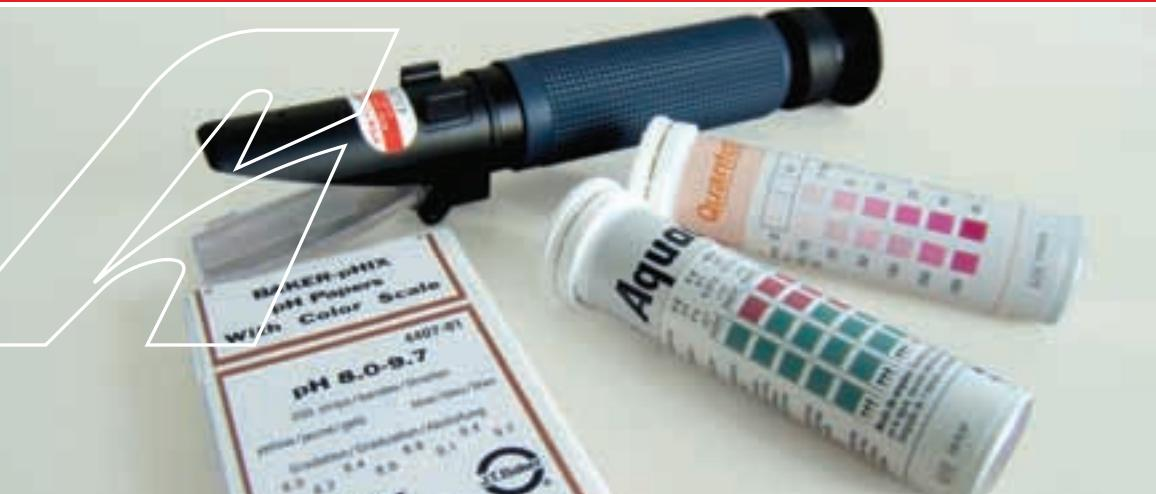
Рефрактометр для измерения концентрации / Refractometer for determining the right concentration.
